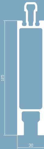
Hochwasserschutzprofil 30 mm H= 125 mm, ca. 3,11 kg/lfm
