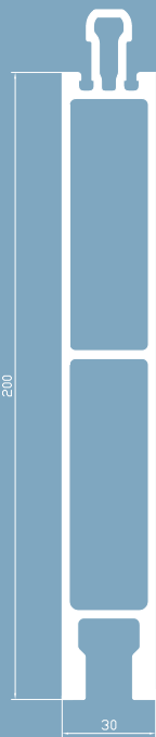
Hochwasserschutzprofil 30 mm H= 200 mm, ca. 4,20 kg/lfm
